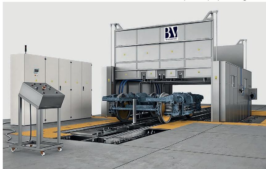
**Waschanlagen für Bahnanlagen** im Eisenbahnsektor sowie im Schiffs- und Automobilsektor bieten spezielle Systeme nach Maß, Gewicht und Qualität. In einigen Fällen müssen die Details nach monatelanger Arbeit von energetischem Fett in jeder Ecke durch Hochdruckwäsche perfekt entfettet werden
